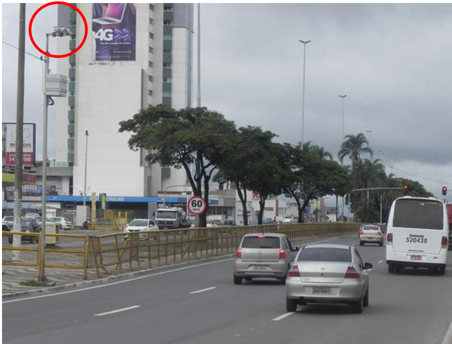
Figura 11 - Monitoramento de três vias utilizando apenas duas câmeras do Tipo 4 (com capacidade de OCR). Local: Taguatinga Centro, próximo à Praça do Relógio.
