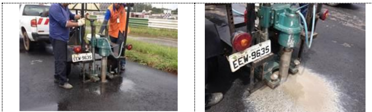
Figura 1 – Coleta de amostras na pista do autódromo
