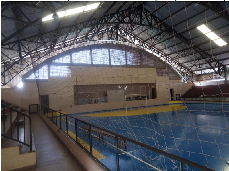
Imagem 8 - Redes de proteção danificadas, falhas de iluminação e ferrugem das estruturas metálicas
