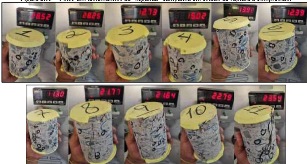
Figura 2.65 – Fotos dos testemunhos da “segunda” campanha em estado de ruptura à compressão.
