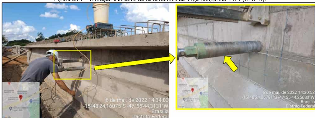
(a) Extração de testemunho.
