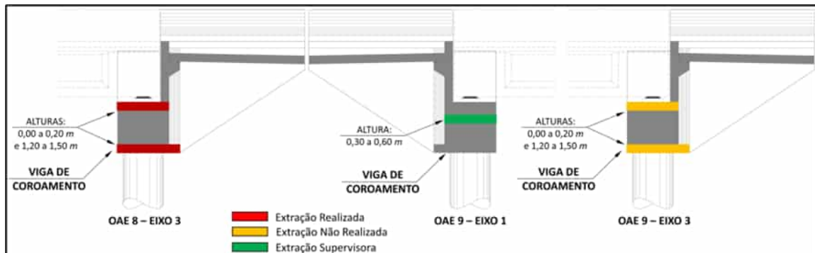
(i) Vigas de Coroamento das OAE 8 e 9 (vista lateral).
