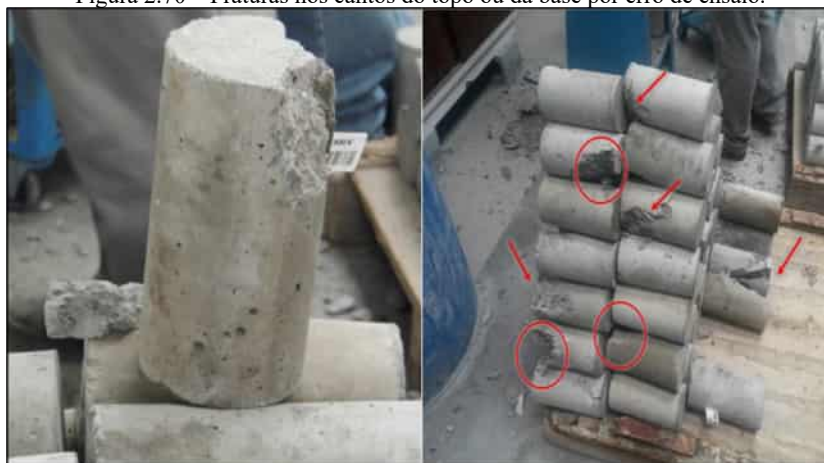
Figura 2.70 – Fraturas nos cantos do topo ou da base por erro de ensaio.
