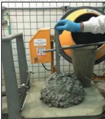
Figura 2.64 – Aspecto ideal do concreto de referência durante ensaio de abatimento.
