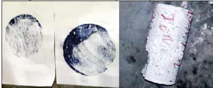
(a) Concentração de carga em determinada área. (b) Fratura localizada no canto.
