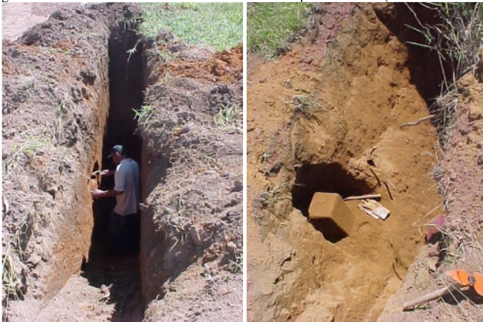
Figura 1.1.1 - Coleta de amostras das trincheiras abertas pela PROGEA (Paralelo 23 - UTM).
