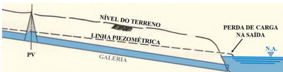
(b) Drenagem forçada, com linha piezométrica acima do topo do conduto.
