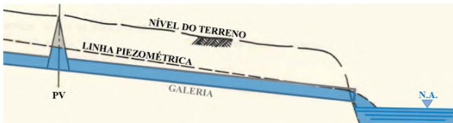
(b) Drenagem forçada, com linha piezométrica acima do topo do conduto.
