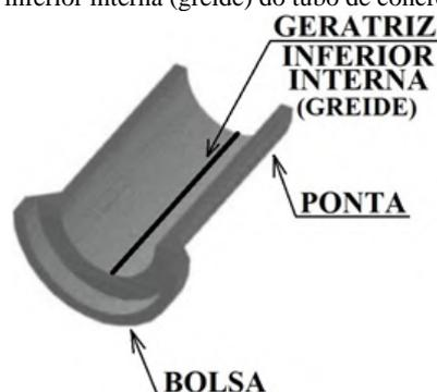
Portanto, a profundidade hidráulica da galeria ( $P_{rf}$ ) corresponde à diferença (desnível) entre a cota de superfície do terreno ( $C_t$ ) e a cota do fundo do conduto ( $C_f$ ), isto é, da geratriz inferior interna do duto. Corroborar nesse sentido o item 3.10, da NBR 9649:1986, da ABNT, que versa acerca de projeto de redes coletoras de esgoto sanitário.
