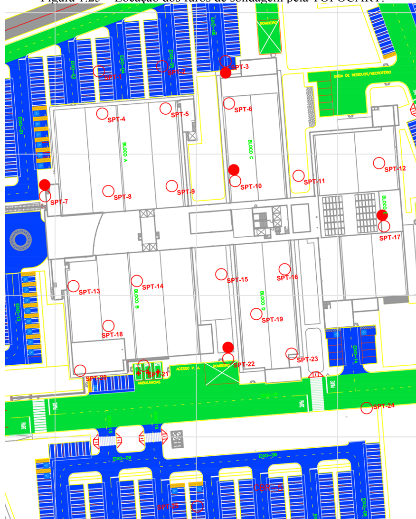
Figura 1.25 – Locação dos furos de sondagem pela TOPOCART.
